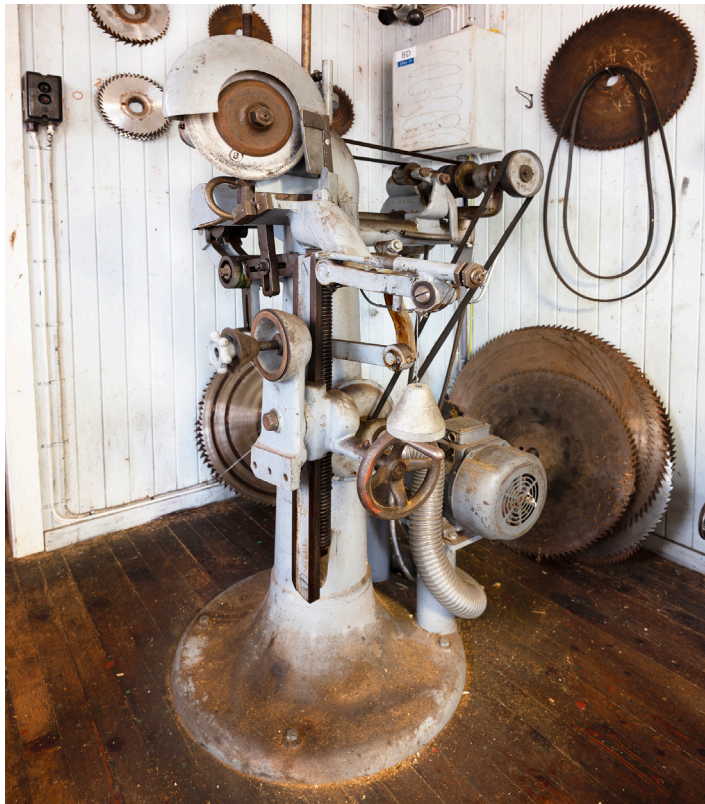
Slipemaskin til sliping av sirkelbladsag, ca. 1920. Samling: Norsk Sagbruksmuseet.
